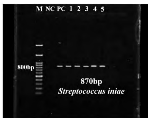
تصویر ۴. نمونه ژل الکتروفورز آگارز (۱/۵ درصد) محصول PCR. M: مارکر ۱۰۰bp، NC: کنترل منفی، PC: کنترل مثبت، چاهک‌های ۱ تا ۵: نمونه‌های استرپتوکوکوس اینیایی .
