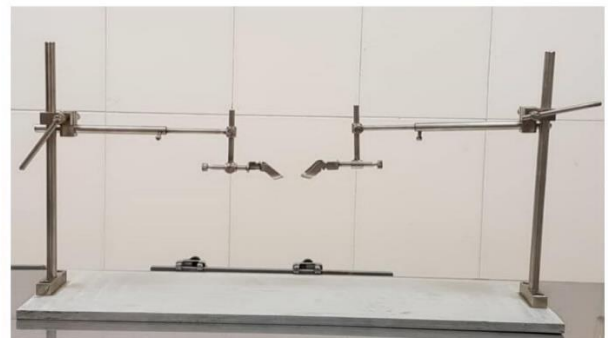
تصویر ۲. پایه‌های نگه دارنده. پایه نگهدارنده دارای دو گیره متحرک است که امکان اتصال به زواید خاری مهره‌های بالا و پایین محل ضایعه را بعد از انجام لامینکتومی فراهم می‌آورند.
